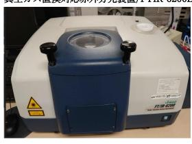
真空・ガス雰囲気での測定が可能なフーリエ変換 赤外分光光度計です。
