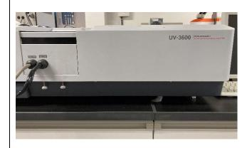
UV-3600 は、精度の高い透過率と反射率の測定に対応し、紫外領域から近赤外領域までを 3 つの検出器でカバーしています。高機能のダブルモノクロメータを搭載し、高分解で低迷光となっています。
