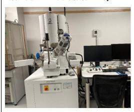
インレンズショットキー電解放出(T-FE)電子 銃と、静電レンズをハイブリッドした強励磁コニ カル対物レンズ(Super Hybrid Lens)の特性を 最大限に発揮できる新電子工学制御機構を搭載 しています。簡単に試料表面の超高分解能観察が でき、EDS,WDS,EBSD,CLD などの各種分析も 行うことができます。
