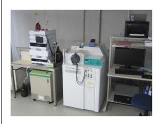
飛行時間型質量分析装置(Time -of-flight Mass Spectrometer, TOFMS)です。電磁気的な相互作用を利用して原子・分子のイオンを質量電荷比の違いによって分析し、原子質量の精密測定や化学分析、有機化合物の原子組成の決定などに使用されます。
