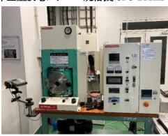
被加工粉体を焼結ステージ上にセットして電極で挟み、加圧しながらパルス通電を行うことで、数分以内で室温より一気に1000~2500℃へ急速昇温、数分で高品位の焼結体を得ることが出来ます。
