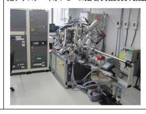
線光電子分光法(XPS)は、試料に X 線を照射することで光電子のスペクトルを測定し、表面の組成、化学結合状態を測定する分析手法です。この装置は Ar クラスターイオン銃を搭載し、試料表面を穏やかにエッチング、より深い層の分析が可能です。
