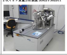
飛行時間型 2 次イオン質量分析(TOF-SIMS)は、非常に高感度な表面分析手法として、多くの産業分野および研究用途でその手法が確立されています。サンプルの表面、薄層、界面における元素および分子に関する詳細な情報を得ることが出来、試料の 3 次元分析も可能です。
