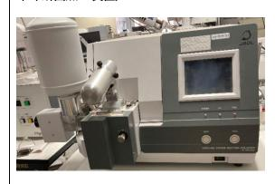
試料面上にセットされた遮蔽板にイオンビームを垂直に照射し、イオン照射を受けエッチングされる領域と、遮蔽板で遮蔽される領域の境界に沿って断面を形成させる試料作製装置です。操作パネルにて試料加工状態を観察できます。
