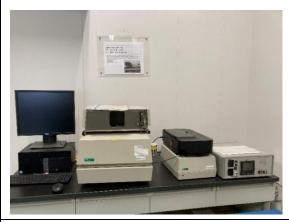
ホール効果測定装置は、導体や半導体の評価に適しています。これにより、サンプル前処理の労力を最小限に抑えながら、さまざまな半導体の抵抗率、キャリア濃度、キャリア移動度を測定できます。 基最大数  $M\Omega/\mathrm{sq}$  までのシート抵抗率と数 $\mu V$  のホール電圧を測定できます。
