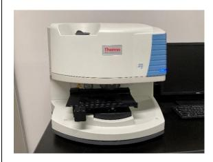
材料表面の化学組成と微視的構造を特徴づける 2Dマッピング機能を備えたオールインワン顕微 FT-IR です。
