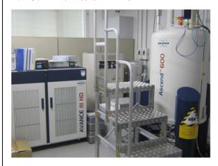
NMRは、物質に含まれるターゲット核のスピン 状態を検出する方法です。この手法により、未知 の材料に存在する元素の種類や構造を予測する ことができます。この装置は5mmの液体プロー ブと3.2mmの CPMAS プローブ (固体測定用) を備えており、要素と構造を決定するさまざまな 実験にお使いいただけます。 また、ソフトウェ ア Icon NMR により簡単に操作ができ、ネット ワーク経由で遠隔操作が可能です。
