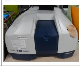
V-670LY は、紫外域用として重水素ランプ、可 | 光源; 重水素ランプ、ハロゲンランプ 視近赤外域用としてハロゲンランプを用いるこ とで、紫外領域から近赤外領域までの連続測定が 可能な装置です。
