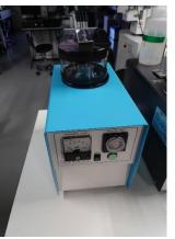
SEM 観察用貴金属薄膜コーティング専用装置で ターゲット: Au す。SEM 試料のチャージアップを防止し、二次 | 試料台サイズ:直径 50mm 電子の発生効率を向上させるための貴金属コー ティングを行います。マグネトロンターゲット電 極による低電圧放電に加えて、試料台をフローテ ィング方式にすることにより、電子線流入による 試料損傷を軽減します。
