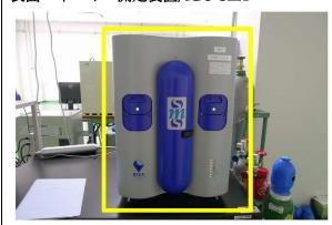
表面エネルギー測定装置 (iGC-SEA) は逆ガスクロマトグラフィー方法論に基づいています。iGC-SEA のカラムにはサンプルが充填されます。プローブガスをカラムに注入し、水素炎イオン化検出器 (FID) によって蒸気の保持時間を測定します。蒸気プローブ分子、流量、温度、またはカラム条件を変えることで、サンプルの表面特性とバルク特性を計算することができます。
