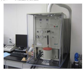
高圧測定を全自動で行うことが可能な高圧ガス吸着量測定装置で、吸着部位、化学状態、および表面積に関する情報を提供します。この装置は、最大 0.9MPa の等温ガス吸着曲線を測定できます。I2CNER 設置のこの装置は、H2 ガス吸着用に設定されています。
