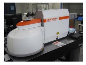
inVia ラマン顕微鏡は、最小でサブμm オーダーの微小物/局所分析が可能な顕微ラマン分光装置です。本装置は一般的に微弱とされるラマン散乱光を高効率で検出、高感度測定が可能です。
