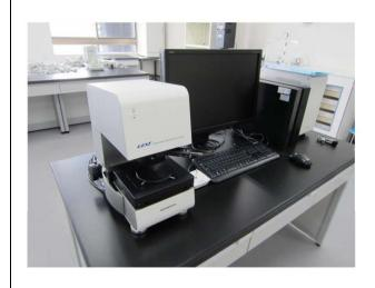
OLS4000 は非接触で試料の検査・測定が可能な 3D 測定レーザー顕微鏡です。正確な測定性能に 加え、非接触表面粗さ測定機として従来の粗さ測 定機では不可能だった測定を可能にします。
