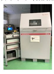
UNHT (Ultra Nanoindentation Tester) は高精度なナノインデンテーション試験機で、ナノスケールでの機械的特性の評価に利用できます。
