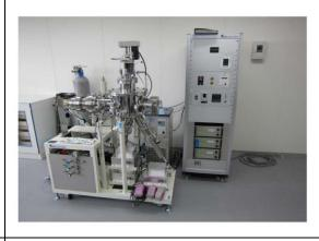
本装置は真空排気したチャンバー内で高周波 (RF)マグネトロンスパッタにより薄膜試料を 作成する装置です。
