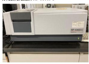
吸光度法と比較して、蛍光感度は数十~数千倍優れています。高い選択性があり、励起・蛍光波長を組み合わせると混合物でも測定可能です。 蛍光は、複雑なバックグラウンドで特定の分子を識別するためにも使用できます。同期スペクトル測定では、蛍光色素の混合物を分析できます。 PC によって直接装置が制御され、データ処理ができます。
