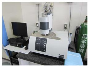
この装置では、-150° C~2400° C の 温度範囲で、重量変化と熱反応の同時測定が可能です。 熱安定性、分解挙動、組成、相転移、溶融プロセスを包括的かつ迅速に分析します。
