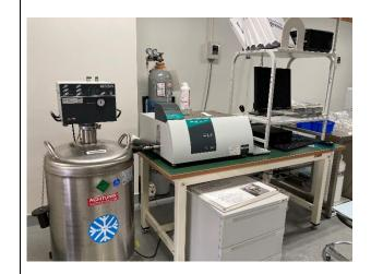
示差走査熱量計 (DSC) は固体、液体の熱特性の 分野において頻繁に使われている装置の一つで す。
