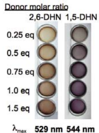
図1 構造異性体ドナー分子(2,6-DHN、1,5-DHN)から作製されたCT膜と最大吸収波長
