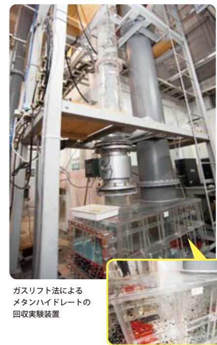
ガスリフト法によるメタンハイドレートの回収実験装置
