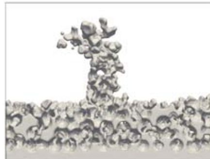
図2 LBMによるCO 2 流動シミュレーション結果。孔隙率分布の異なったスリット上の構造を作ることにより異方的なCO 2 流動を再現した。
